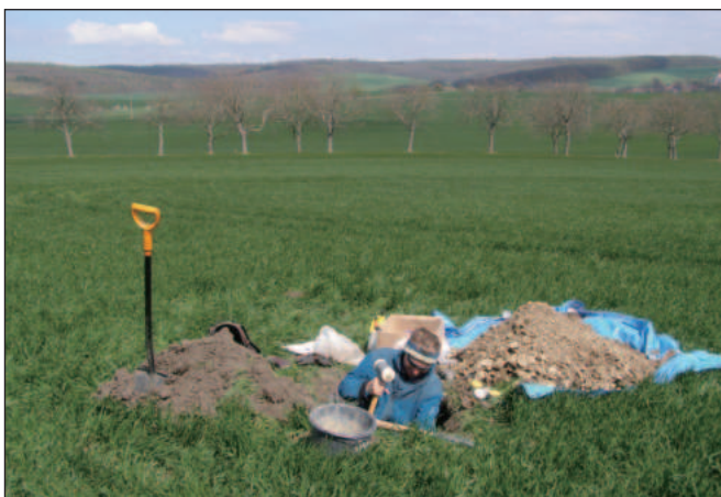
Odběr vzorků z půdní sondy v povodí Uhřetího rybníka
