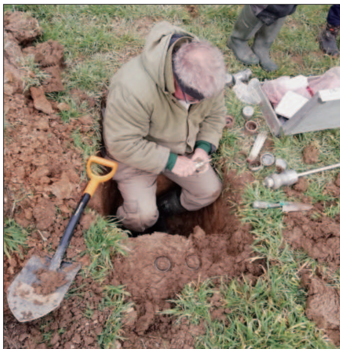
Odběr fyzikálních válečků v povodí Černičí
